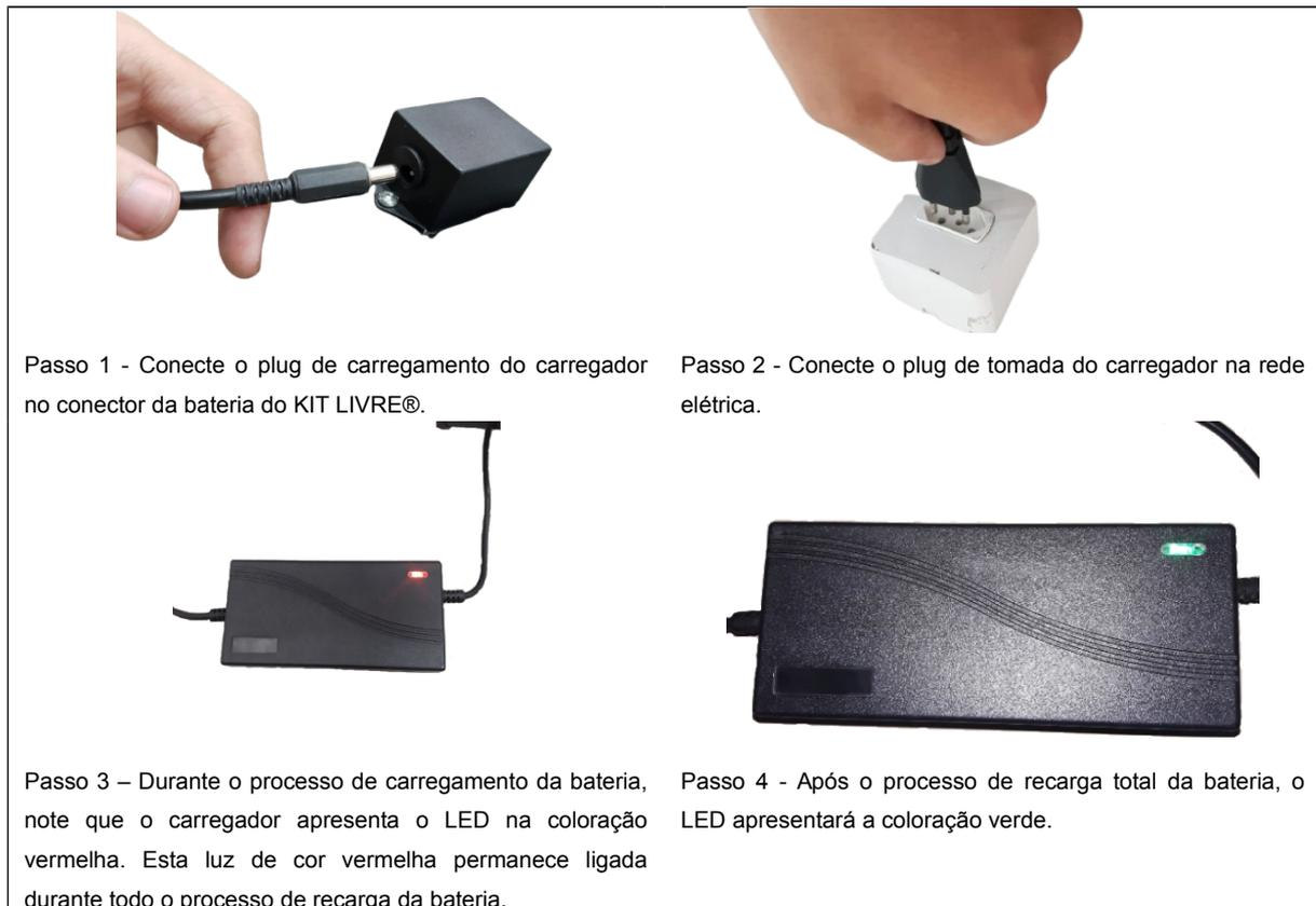
Figura 12 – Processo de recarga da bateria do KIT LIVRE®.
