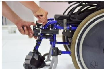
Passo 8: Instalar o acoplamentos laterais (2,17,18).
