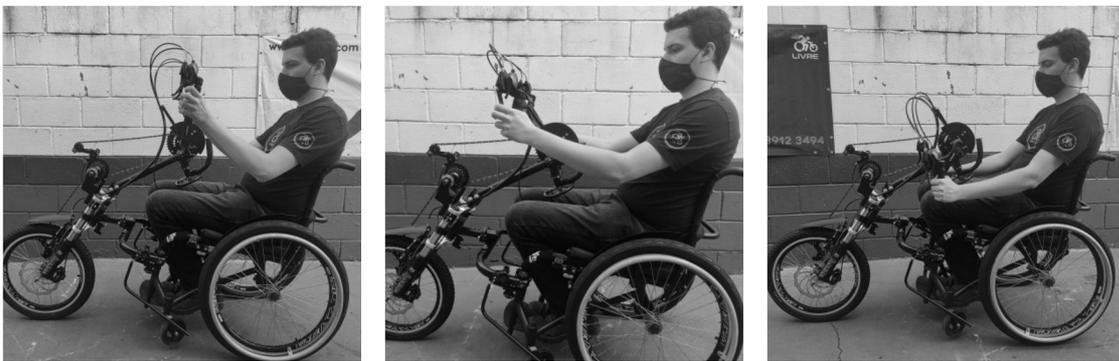
Figura 46 – Movimento de propulsão do dispositivo.
