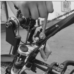
Passo 10: Apertar o parafuso M8 da coluna de direção do KIT LIVRE®. Utilizar as **chave Allen 6 mm (11)** e **combinada 13mm (16)**.
