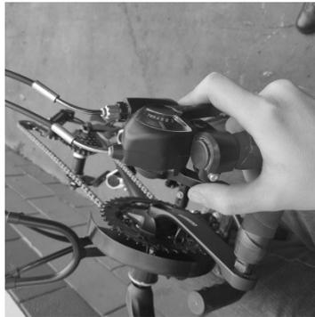
Figura 48 – Trocador de Marcha Shimano 7 Speed.
