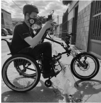
Figura 36 - Subida de calçadas com o KIT LIVRE®, posicionamento do tronco (3ª posição) – \* Imagem meramente ilustrativa.
