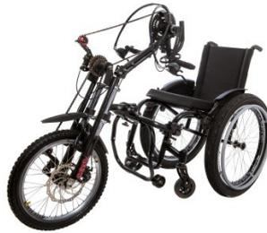
Figura 26 –KIT LIVRE® Radical Hand acoplado a uma cadeira de rodas – \* Imagem meramente ilustrativa.
