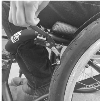
Figura 27 - Travamento dos freios de estacionamento da cadeira de rodas – \* Imagem meramente ilustrativa.
