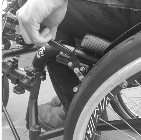
Figura 25 - Destrramento dos freios de estacionamento da cadeira de rodas – \* Imagem meramente ilustrativa.
