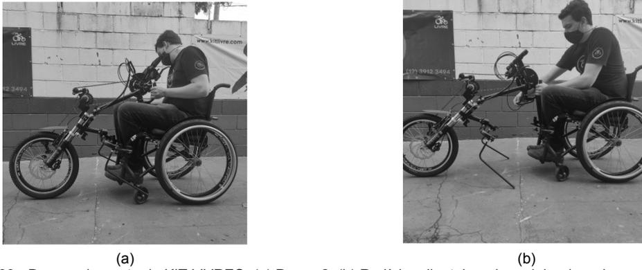
Figura 30 - Desacoplamento do KIT LIVRE®: (a) Passo 2; (b) Rodízios dianteiros da cadeira de rodas apoiados ao solo – \* Imagem meramente ilustrativa.
