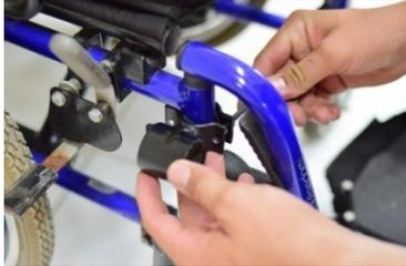
Passo 1: Instalar o 1º mancal de apoio (9,10,21,22). Utilizar chave Allen 5 mm (12).
