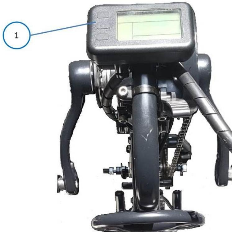
Figura 7 – Painel de Controle no guidão – KIT LIVRE® Radical Flex 600W– \* Imagem meramente ilustrativa.
