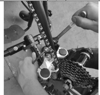
Passo 9: Inserir o parafuso M8 da coluna de direção na posição adequada.
