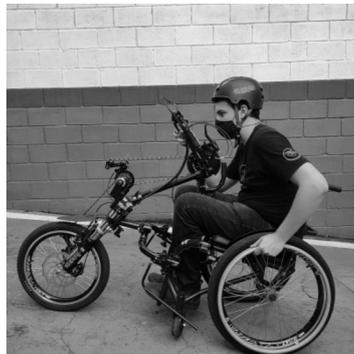
Figura 42 - Subida de rampa com o KIT LIVRE®, auxílio de propulsão na cadeira de rodas – \* Imagem meramente ilustrativa.
