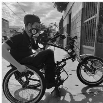
Figura 35 - Subida de calçadas com o KIT LIVRE® com auxílio de propulsão na roda traseira – \* Imagem meramente ilustrativa.
