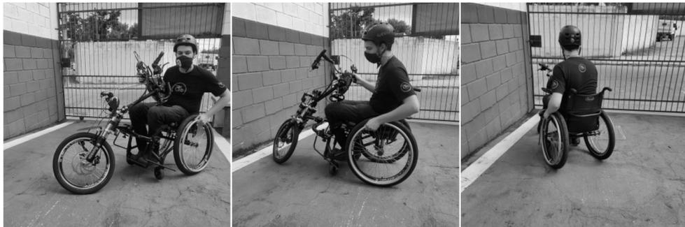
Figura 44 - Paralisação da subida com o KIT LIVRE® e manobra para descida – \* Imagem meramente ilustrativa.
