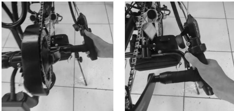
Figura 47 - Acionamento do acelerador do KIT LIVRE® – \* Imagem meramente ilustrativa.
