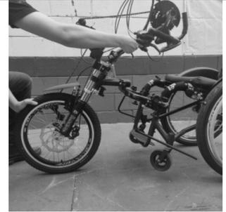
Passo 6: Levantar o KIT LIVRE® para travar os acoplamentos laterais (17,18).
